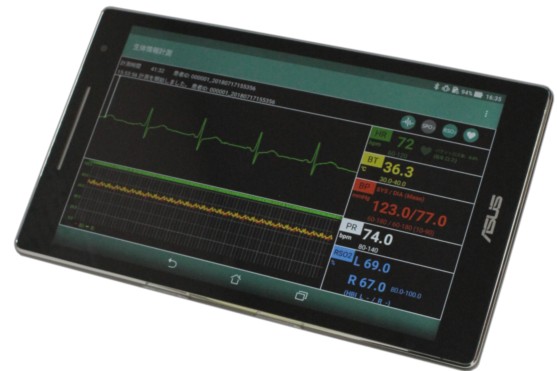
フジタ医科器械と共同開発中のスマートデバイス型生体情報モニタ
